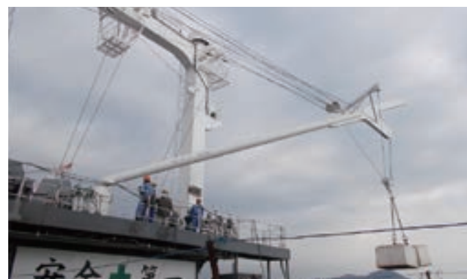
▲デリック装置荷重試験の様子
